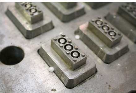
Abb. 102 | Unterseite eines LEGO-Spritzgusswerks
