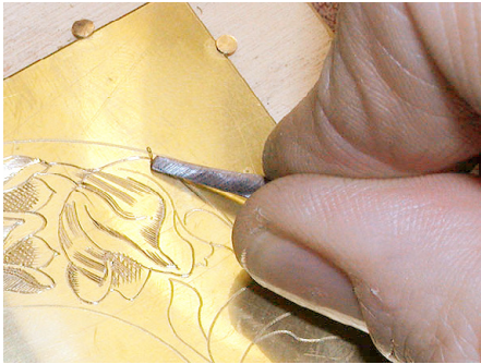
Abb. 107 | Mit einem Stichel verziert ein Graveur eine Messingoberfläche.
