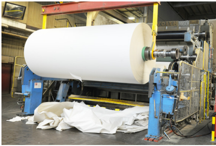
Abb. 110 | Die Papiermaschine übernimmt die eigentliche Produktion. Das fertige Papier wird anschliessend auf grosse Rollen aufgewickelt.
