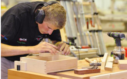
Abb. 95 | Ein Möbelschreiner bei der Fertigung eines Schubladenelements
