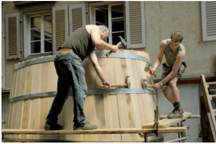
Abb. 100 | Küfer bei der Herstellung eines Eichenfasses
