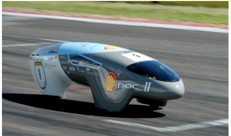
Abb. 17 | Mit 8 l rund um die Welt – der von der ETH Zürich entwickelte PAC-Car II
