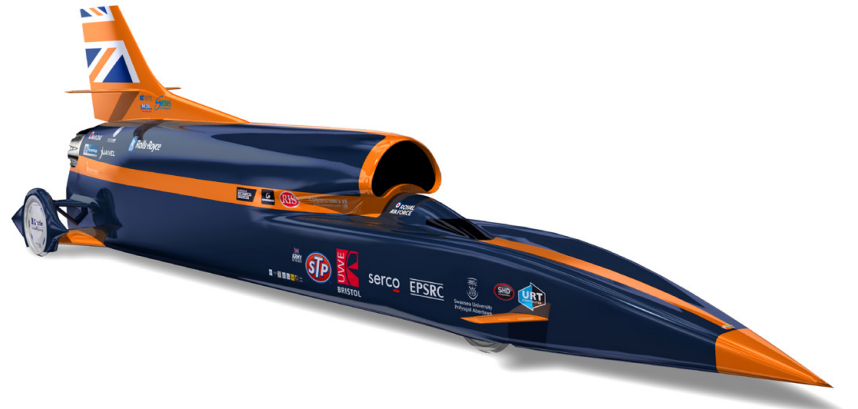
Abb. 13 | 4,5 Fussballfelder in einer Sekunde, 150 m in einem Wimpernschlag, schneller als eine Pistolenkugel, seine eigene Länge in weniger als drei Hundertstel einer Sekunde – der Bloodhound SSC soll über 1000 mph (1609 km/h) erreichen.
