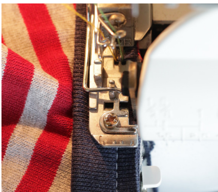
Abb. 92 | Position des Nähguts unter der Overlockmaschine
