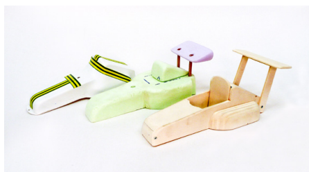
Abb. 175 | Karosserieentwicklungen mit Polystyrol (tiefgezogen), Polystyrolschaumstoff und Sperrholz
