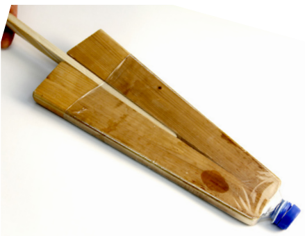
Abb. 283 | Flasche schrumpfen mittels Holzform und Heissluftföhn.
