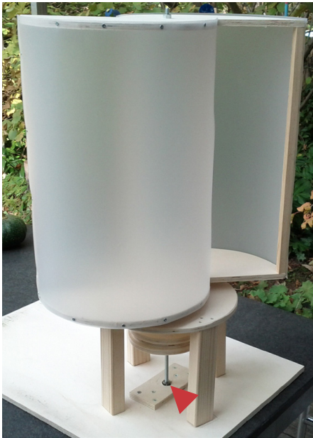
Abb. 274 | Savonius-Windrad mit Feststellschraube
