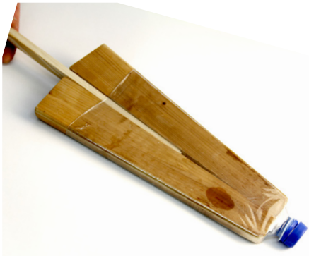
Abb. 268 | Schrumpfform mit Keil zum Spannen
