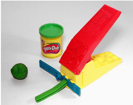
Abb. 127 | Kolbenextrusion von Knetmasse mit einem Kinderspielzeug
