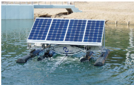
Abb. 203 | Ein bewegtes Oloid wälzt Flüssigkeiten effizient und schonend um.
