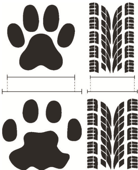
Abb. 150 | Ähnlich wie Katzenpfoten verbreitern sich die Autoreifen beim Abbremsen. Die Bremsfläche wird dadurch vergrößert und der Bremsweg verkürzt.
