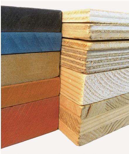
Abb. 21 | links: MDF-Platten sind in verschiedenen Farben erhältlich. rechts: Sperrholz und Dreischichtplatten. Charakteristisch sind die verschiedenen sichtbaren Furniere, die kreuzweise verleimt wurden.
