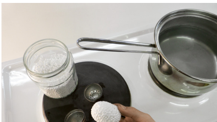
Abb. 48 | Nach einer ersten Trocknungsphase wird das vorgeschäumte Material in eine Stahl- oder Aluminiumform (hier ein Tee-Ei) gegeben. Die Form wird bis oben gefüllt und geschlossen. Nun wird über Düsen Dampf eingeblasen, der über andere Düsen wieder abgeführt wird. Durch die Hitze bläht sich das Material weiter auf. Es entsteht ein enormer Druck in der Form, und die Kügelchen verkleben zu einem grossen Block.
