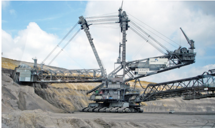
Abb. 213 | Der Schaufelradbagger 288 bei der Arbeit
