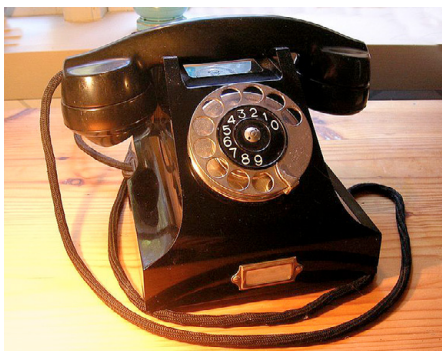
Abb. 37 | Bakelit wurde zur Herstellung vieler alltäglicher Produkte, z. B. eines Telefons, verwendet.
