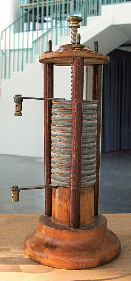
Abb. 116 | Nachbau einer voltaschen Säule. Zink- und Kupferplatten werden durch in Salzlösung getränkte Pappstücke getrennt. Verbindet man die beiden Endplatten miteinander, fließt Strom.
