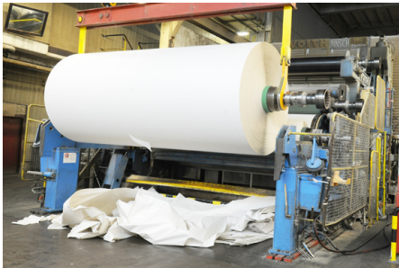
Abb. 134 | Die Papiermaschine übernimmt die eigentliche Produktion. Das fertige Papier wird anschliessend auf grosse Rollen aufgewickelt.
