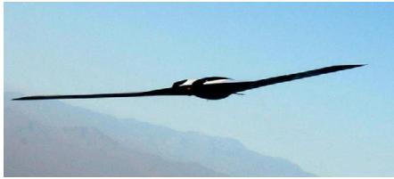
Abb. 179 | Das unbemannte Flugzeug Lockheed Polecat besteht zu einem Grossteil aus gedruckten Kunststoffbauteilen.
