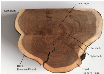
Abb. 32 | Schematischer Aufbau eines Baumstamms. Die Farbunterschiede zwischen dem Früh- und Spätholz sind bei diesem Baumstamm deutlich sichtbar. Zusammen bilden die beiden Schichten einen Jahrring. →I-09
