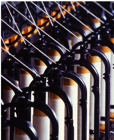
Abb. 297 | Vor dem Ringspinnen wird das Streckband auf der Flügelspinnmaschine (Flyer) zu einem Vorgarn, der Lunte, vorgespinnnen.
