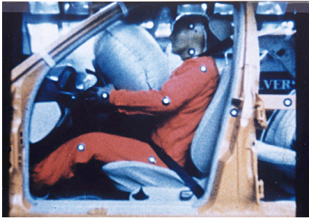
Abb. 112 | Bei einem Aufprall lösen Sensoren den Airbag aus, der sich innerhalb von Millisekunden aufbläst.
