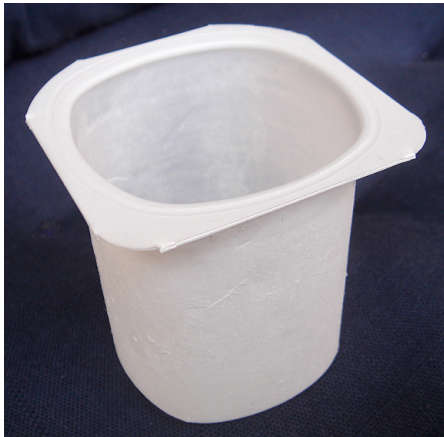
Abb. 49 | Im Tiefziehverfahren lassen sich u. a. Joghurtbecher aus Polystyrol herstellen.
