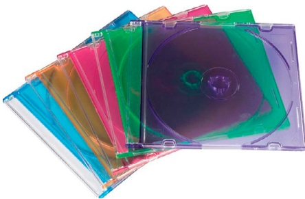
Abb. 50 | Viele Formteile aus Polystyrol werden im Spritzgiessverfahren hergestellt, z. B. CD-Hüllen. Kennzeichen ist ein kleiner Punkt, der als Ansatzpunkt der Einspritzdüse übrig bleibt und bei jedem Spritzgiessteil zu finden ist.
