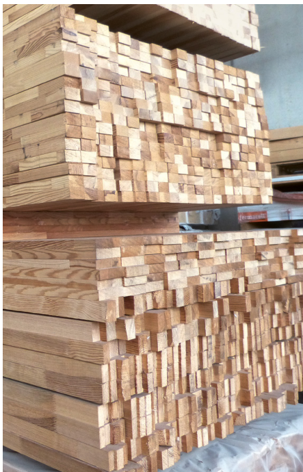
Abb. 23 | Ein Kantholz darf höchstens dreimal so breit sein, wie es dick ist
