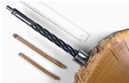
Abb. 33 | Mithilfe solcher Spezialbohrer können Proben aus dem Baumstamm entnommen werden. Alter und Wachstumsbedingungen können abgelesen werden, ohne dass der Baum gefällt werden muss.
