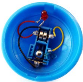
Abb. 139 | Analyse des Fliehkraftschalters eines Leuchtdiodenkreises
