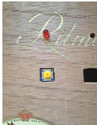
Abb. 306 | Löcher für Schalter, LED und Taster
