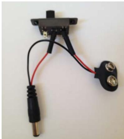
Abb. 304 | Durchgetrennter Batterieclip mit Schrumpfschlauch und Schalter.
