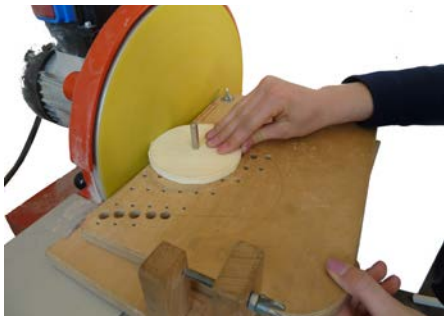
Abb. 155 | Schleifhilfe für Räder, geeignet für Holz- und Kunststoffräder aller Dicken (Bezug www.do-it-werkstatt.ch )
