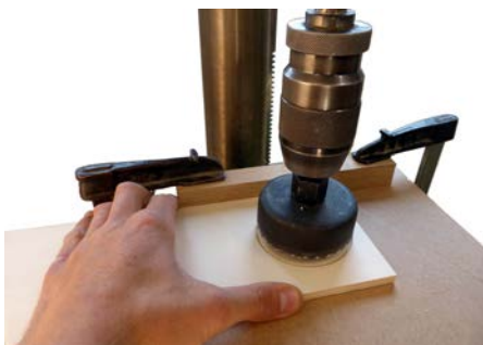
Abb. 157 | Glockensäge nur mit Anschlag benutzen.
