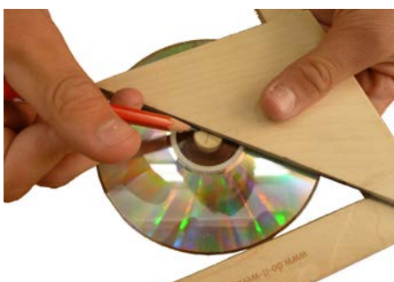
Abb. 158 | Mit dem Zentrierwinkel Mitte bestimmen.
